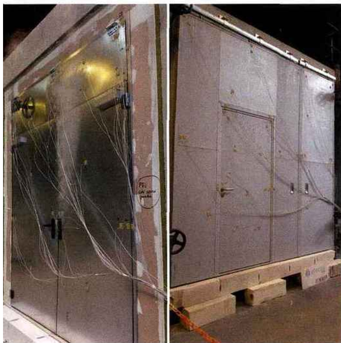
Essai EI porte battante deux vantaux avec imposte signée Portafeu
